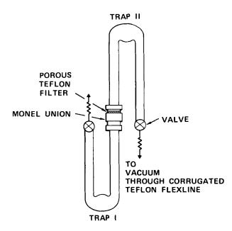
Fig. 2. Apparatus for syntheses of  $[NF_4][HF_2]$ ,  $[NF_4]_2[MnF_6]_2$ ,  $[NF_4]_2[SiF_6]$ , and  $[NF_4][WOF_5]$ .
