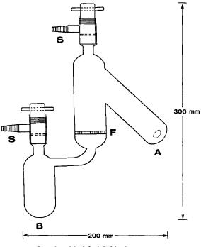
Fig. 1. Modified Schlenk apparatus.
