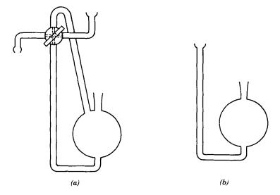
Fig. 1. a. Zwickel flask. b. Bubble flask.
